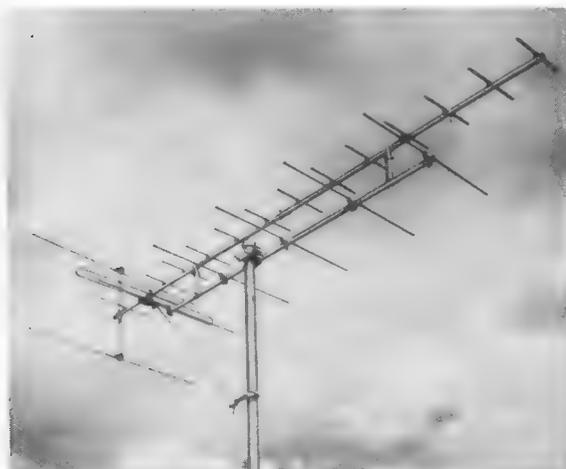
Eine ungewohnte Form zeigt die Hirschmann-Antenne Fesa 23 OLH. Die Direktoren für den Bereich III sind unterhalb der Empfangsebene des Bereiches IV angeordnet
