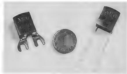
Bild 1. Ausführungsformen der AEG-Amplitudenbegrenzer AB 10/2
