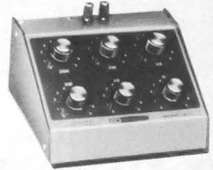
Bereich:  $1\Omega \dots 999.999\Omega$  (6stufig)
